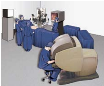
Assemblaggio della sala operatoria robotica. Il chirurgo opera seduto alla consolle a distanza dal paziente
